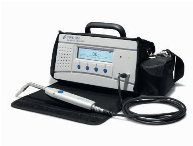
Sensistor ISH2000C - переносной блок на батареях для использования в жестких условиях среды
